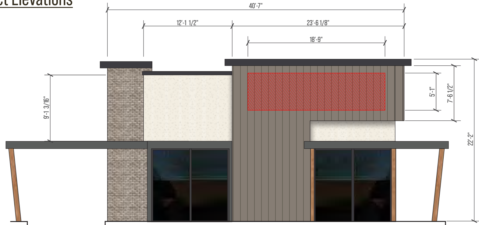
1 Exterior Elevation - West Scale: 1/8" = 1'-0"
